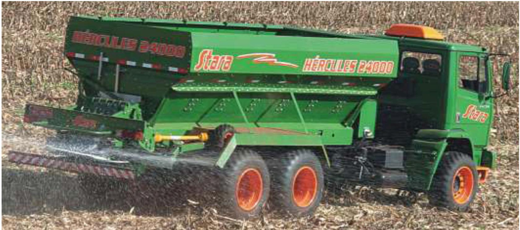
**CENTRÍFUGO COM DOIS DISCOS COM DOSADOR VOLUMÉTRICO TIPO ESTEIRA LONGITUDINAL CENTRAL**
