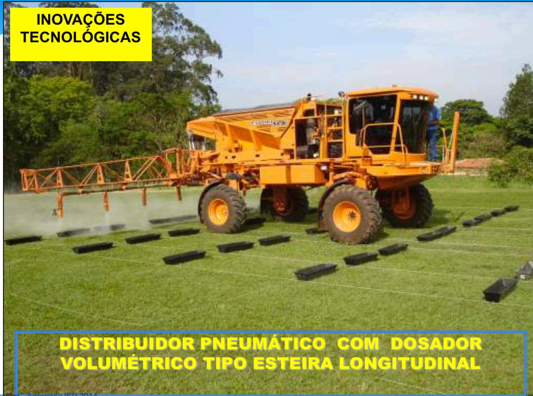
**DISTRIBUIDOR PNEUMÁTICO COM DOSADOR
